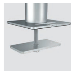
Przykręcane mocowanie do biurka do grubości blatu od 14 do 44 mm i w otworze w blacie o średnicy od 60 do 80 mm
